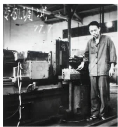
调试自己设计的钻床加工多孔组合机床 1977.7盐城农机厂
